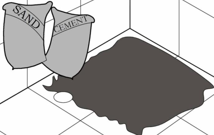
Installer le receveur sur une légère couche de ciment. Prenez note qu'en rajoutant de l'eau au mélange adhésif, le collage sera renforcé; il est conseillé d'appliquer une couche de base avant l'installation du receveur.
