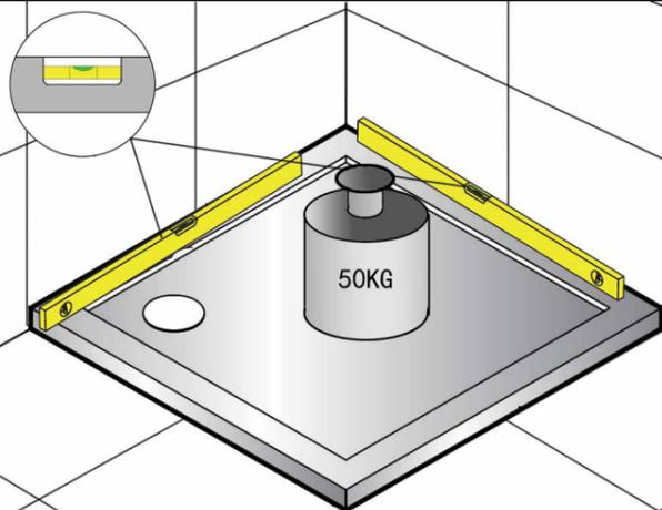
Mettre le receveur à niveau et laissez-le immobilisé pendant 24 heures.
